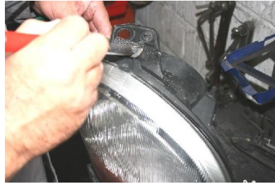
Réparation d'une optique de phare
